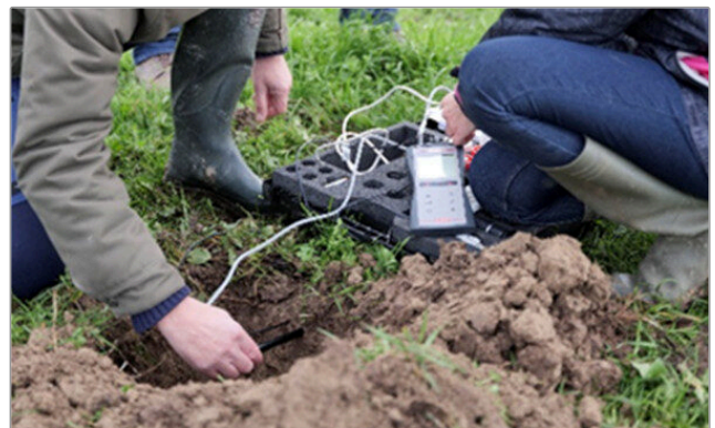
Figure 12. – Mesure de terrain : la sonde est mise en contact intime avec le sol en place, le millivoltmètre affichant directement la valeur en mV.
