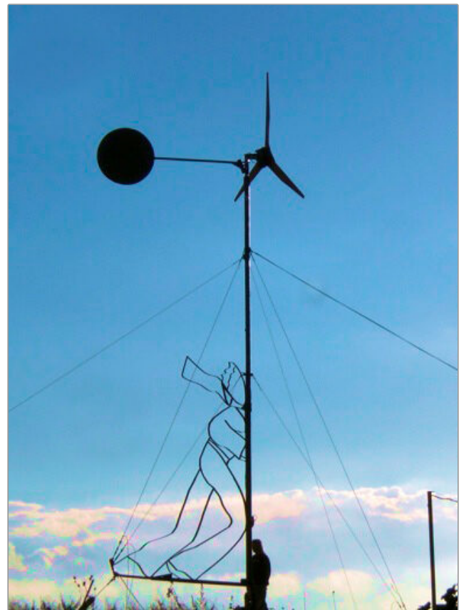
Figure 2. – Éolienne Piggott en fonctionnement : hélice tripale, nacelle orientable et safran de mise au vent.
