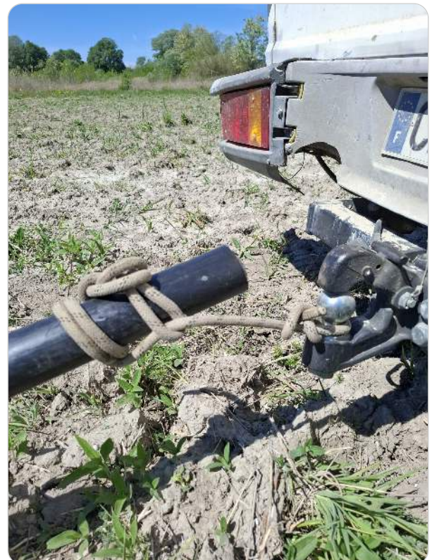
Fig. 12. – Détail du nœud d'attache pour traction
