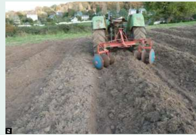
1 Radis sur butte avec enherbement spontané 2 Planche buttée avec une butteuse à asperge
