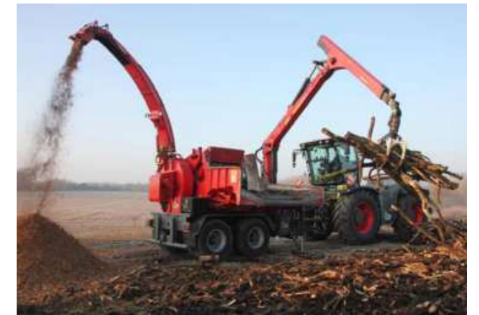
Broyage avec bras articulé.
