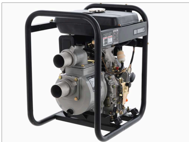
Figure 1. – La motopompe Blackstone BD 8000ES : moteur diesel D300 (296 cm 3 , ≈ 4 kW), pompe auto-amorçante de 80 mm (1 000 L/min), démarrage électrique, réservoir de 14 L (≈ 22 h d'autonomie). Le cadre tubulaire offre de nombreux points de fixation pour le boîtier et le servo-moteur.
