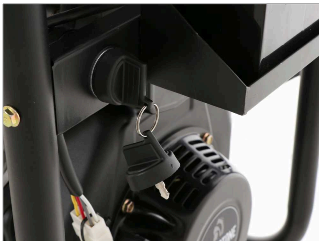
Figure 2. – À gauche : le contacteur à clé — un interrupteur rotatif que l'on peut doubler par un relais, sans le modifier. À droite : la batterie 12 V — 22 Ah livrée avec la pompe : elle alimentera aussi notre boîtier de télécommande.
