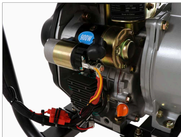
Figure 3. – Le démarreur électrique de 900 W et, à gauche sur le radiateur à ailettes, le régulateur de charge : moteur en marche, un petit alternateur intégré recharge la batterie — la tension monte à 13,5–14,4 V, signal que notre carte exploitera pour savoir que le moteur tourne.
