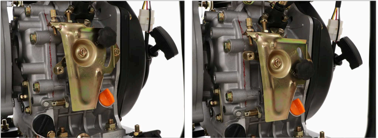
Figure 4. – Le levier de coupure d'injection sur son support en tôle pliée : à gauche en position STOP (levier en haut, gazole coupé), à droite en position START (levier en bas, moteur autorisé à tourner). Le support offre des perçages tout trouvés pour fixer l'équerre du servomoteur.
