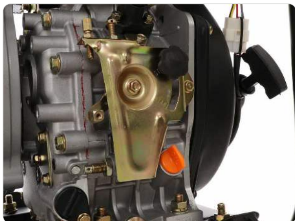
Fig. 3. – STOP — levier en haut : le gazole est coupé, le moteur s'arrête en quelques secondes.
