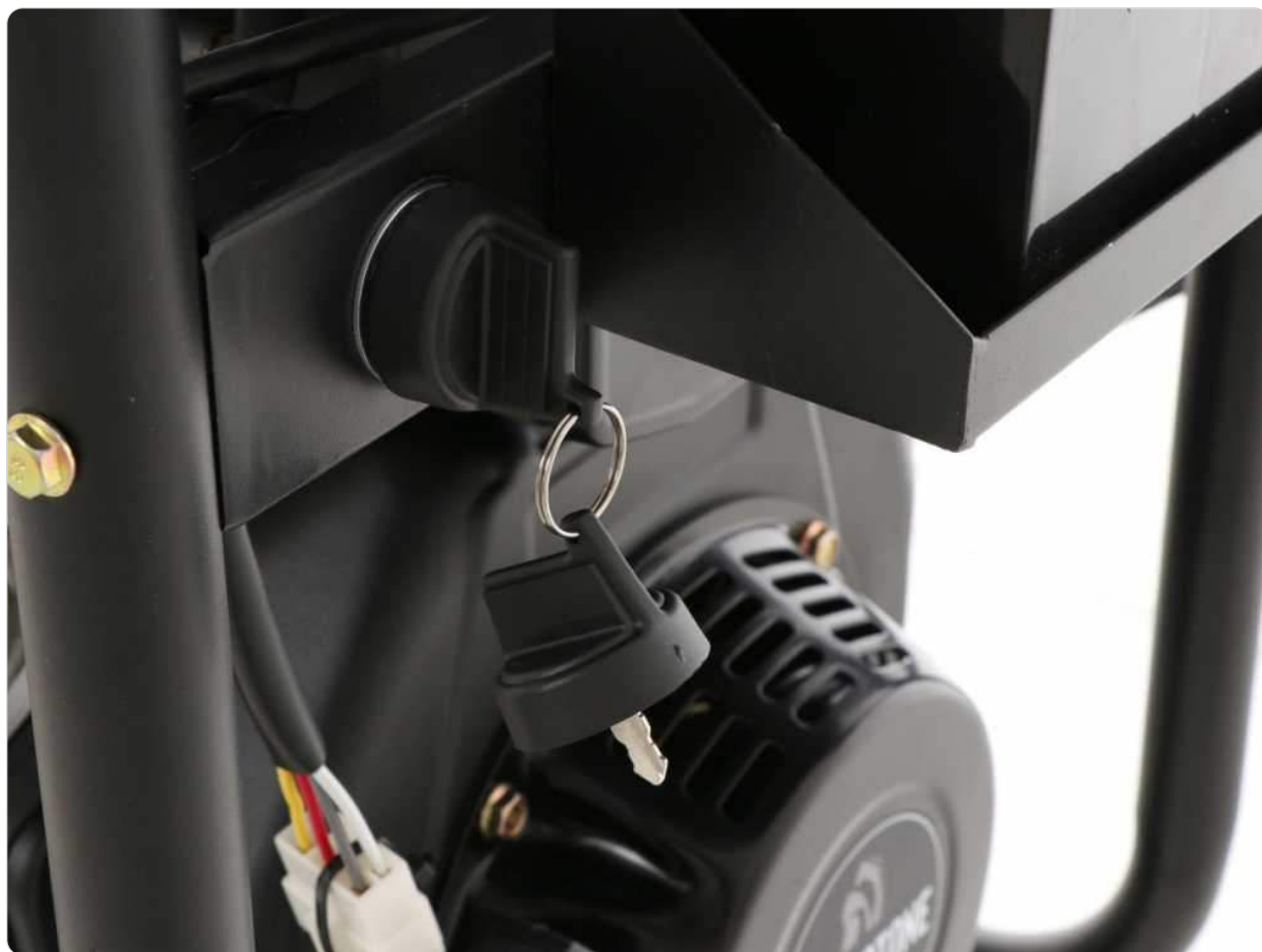
Fig. 2. – Le contacteur à clé . Il alimente le démarreur — et rien d'autre.
