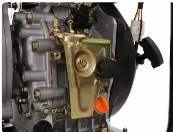
Fig. 4. – START — levier en bas : l'injection est active, le moteur peut tourner.
