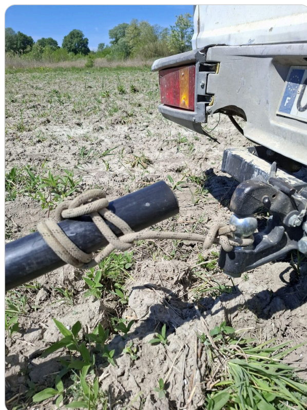
Fig. 12. - Détail du nœud d'attache pour traction
